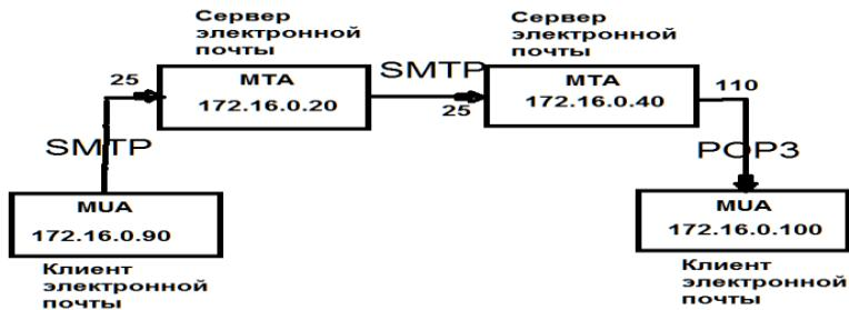
Рис. 3.3. Схема взаимодействия с прикладными почтовыми протоколами в исследуемой сети
