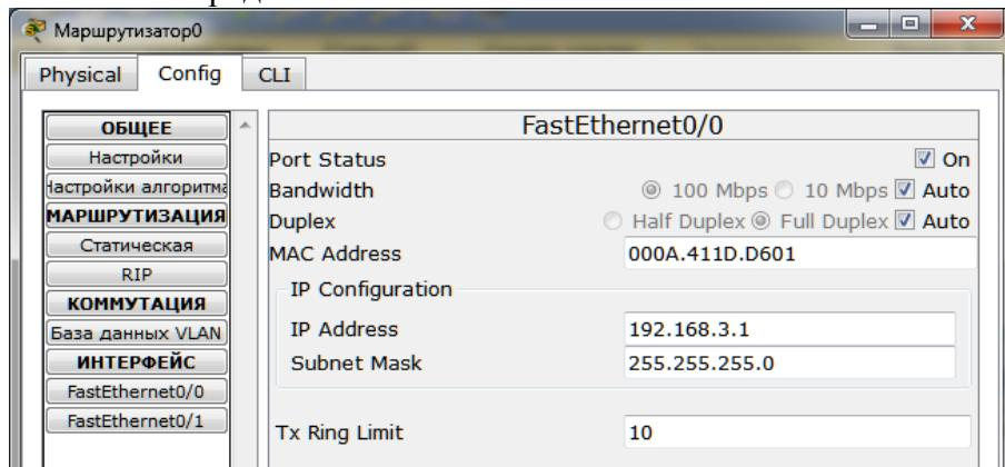
Рис. 2.2. Настройка интерфейса FastEthernet0/0 маршрутизатора
